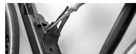
Kontrolliere den festen Sitz der Schrauben und setze das Faltschloss zurück in die Halterung. Verschließe dann die Schlosshalterung mit dem Gummiband.
