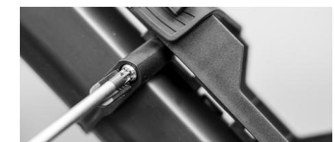
Kontrolliere den festen Sitz der Schlosshalterung und setze das Faltschloss zurück in die Halterung. Verschließe die Schlosshalterung mit dem Gummiband.
