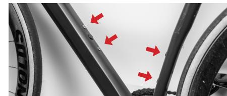
Suche eine passende Stelle am Fahrradrahmen für die Schlosshalterung aus. Umschließe den Fahrradrahmen mit den Verschlussbändern. Stelle sicher, dass die Verschlussbänder straff am Rahmen anliegen.
